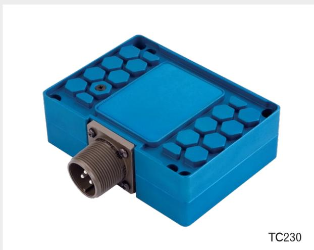
Die Umrichter der TC230-Serie wiegen nur 0,32 Kilo und liefern eine Leistung von 230 Watt vom vorhandenen 10–18-V-DC-Eingang des Flugzeugs zur Versorgung von Zubehör mit 28 V DC. Das hocheffiziente, lüfterlose Design des TC230 reduziert das Gewicht und bietet eine flexible Installation.
